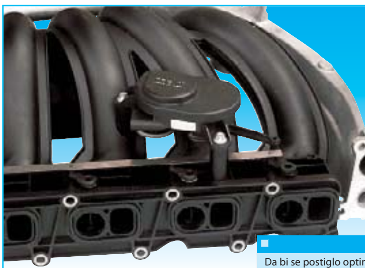
Sl. 41 Usisna grana sa regulacionim leptirima i elektromotornim aktuatorom EAM-i
