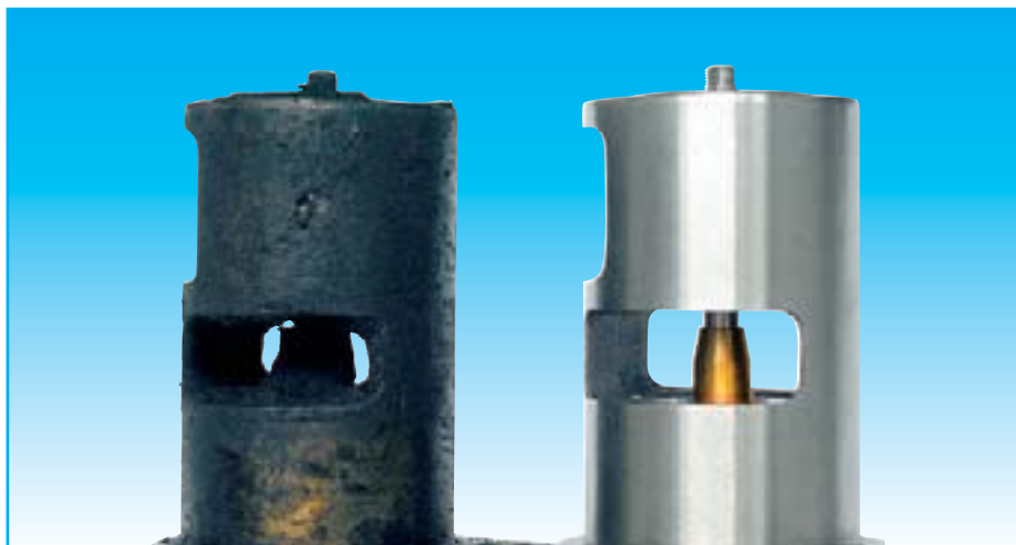
SI. 38 Ventil EGR (dizel motor) sa obilnim naslagama i nov ventil EGR
