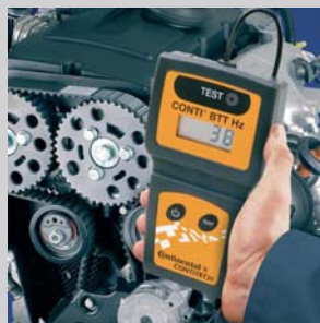
CONTI® BTT Hz (Belt Tension Tester): Elektronička alternativa mjerenju zategnutosti rebrastih klinastih remena
