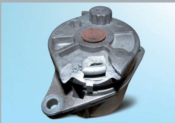
Slika 3: Primjer slomljenog španera 55123
