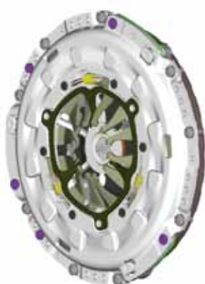
Sklop spojke sastavljen od lamela spojke i potisne ploče
