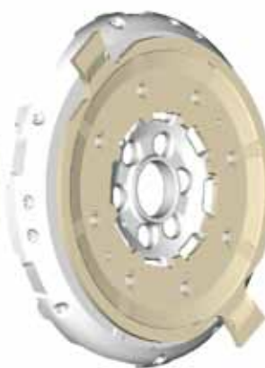
Sekundarna masa zamašnjaka podijeljene mase prirubnicom
