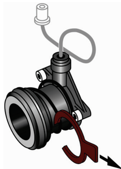
Slika 3: Uklanjanje osiguraaa za transport
