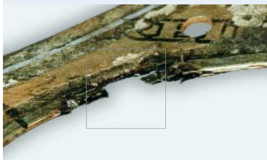
Uvlačenje i gnječenje sa i bez prođuvavanja, izazvano detonantnim sagorevanjem.
