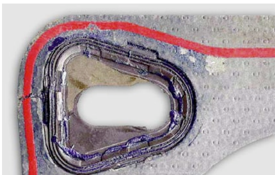
Cepanje i kidanje kompozitnog materijala i oštećenje elementa od Vitona zbog neodgovarajuće primene zaptivne mase.
