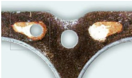
Bubrenje kompozitnog zaptivača glave zbog pregrevanja sa nastankom pare.
