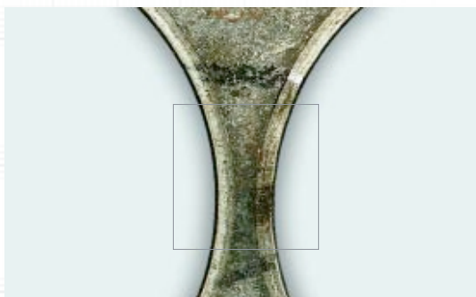
Isticanje gasova sa lokalnim zacrnjenjem ruba oko otvora za cilindar.
