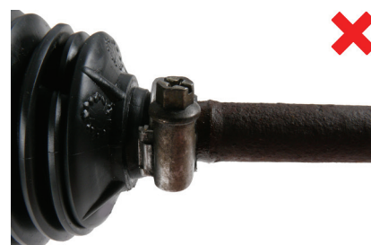
Fig. 3: Zupčasta letva sa korozijom
