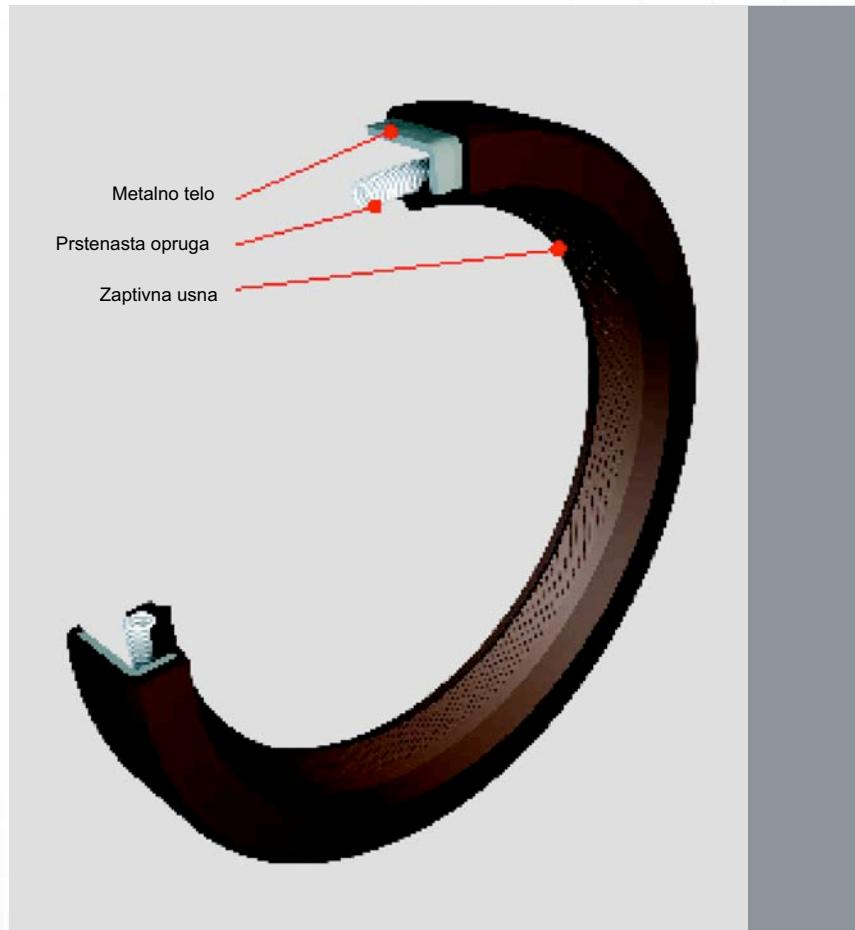
Konstrukcija konvencionalne radijalne zaptivke sa prstenastom oprugom.
