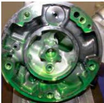
Uzrok je pogrešna ili previše UV boje, i/ili univerzalno ulje koje reducira viskozitet i podmazivanje. (Savjet: isprati klima uređaj sa hladivom, da se očisti od ulja i ostalih tekućina).
