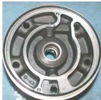
Uzrok je nedovoljno hladiva ili ulja za kompresor u klima uređaju, što dovodi do pregrijavanja kompresora. (Indikacija: crni talog na usisnoj strani).
