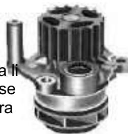
Pravilo je da nema potrebe za upotrebotom brtvene mase kad se **O-prsten** ugrađuje na pumpu. Takođe, nema potrebe za upotrebotom brtvene mase u slučaju kad se brtva (papirna ili gumena) koristi za ugradnju. U ovo slučaju je potrebno papirnu brtvu namočiti vodom za lakšu ugradnju.
