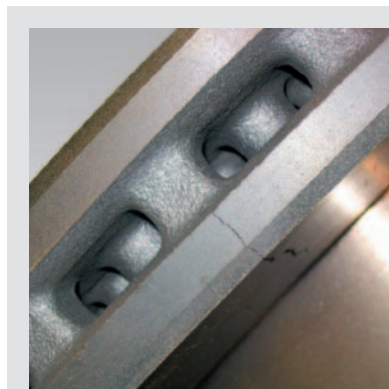
► Cracked brake disc
