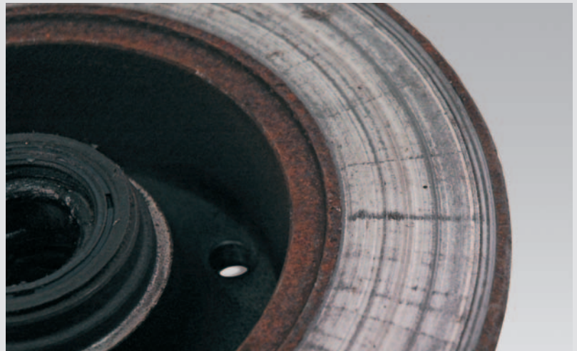
► Corroded brake disc
