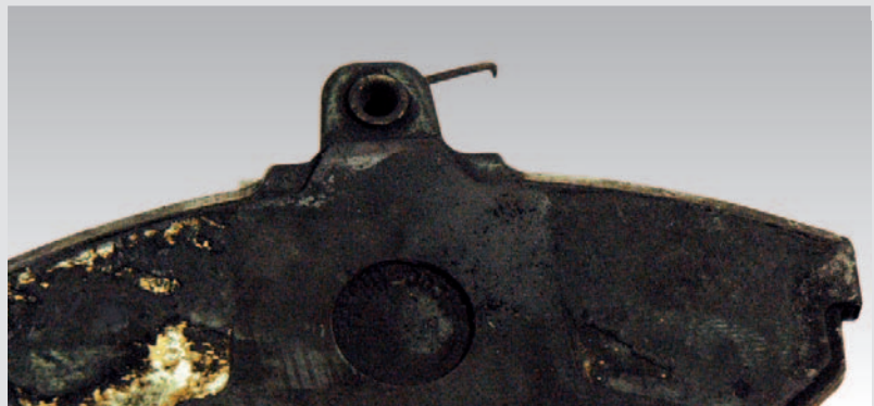
► Hold-down spring broken
